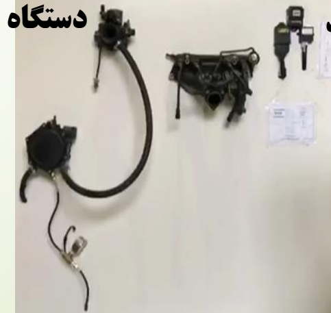
تابلو سوخت رسانی گازی
