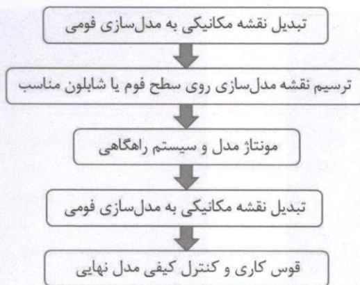
▲ شکل ۴- فلوجارت مراحل کلی ساخت مدهای فومی با روش نیمه اتوماتیک و روش دستی.
